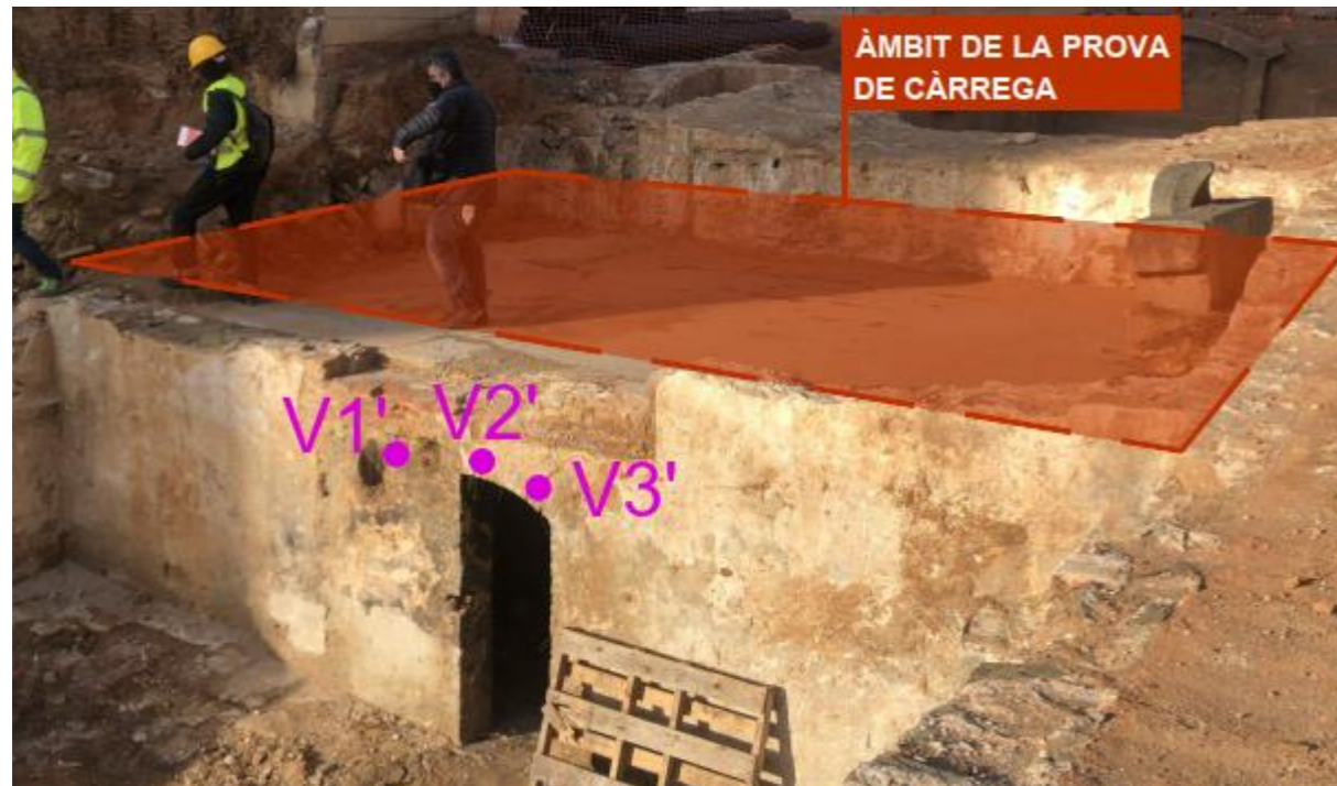
Figura 30. Posicionament dels punts VI en el frontal de la volta del carcabà superior.
