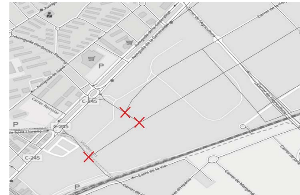
Figura 69: Interseccions principals en el viari intern amb proposta de senyalització semafòrica. Font: Elaboració pròpia
