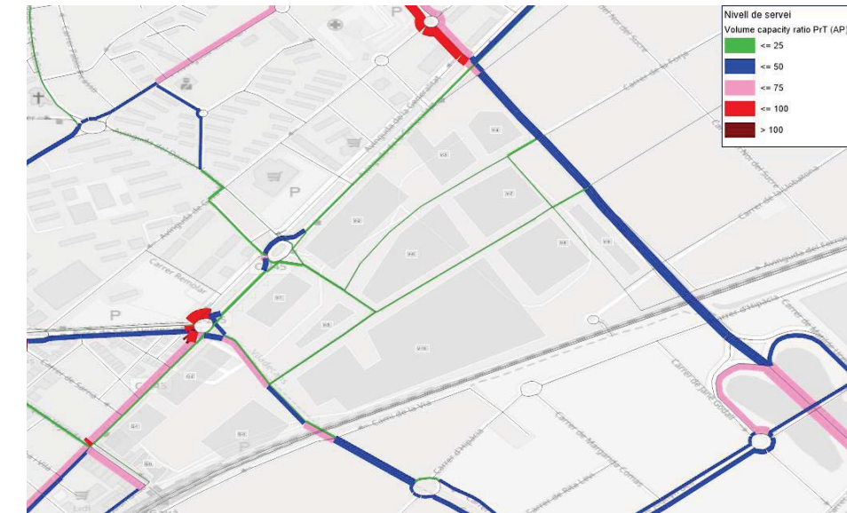
Figura 58: Detall del nivell de servei del viari intern. Font: Elaboració pròpia
