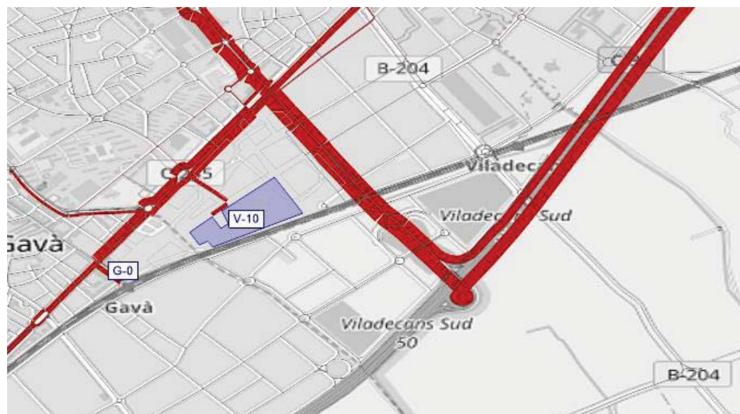
Figura 59: Resultat de l'assignació del trànsit actual en hora punta del matí. Font: Elaboració pròpia
