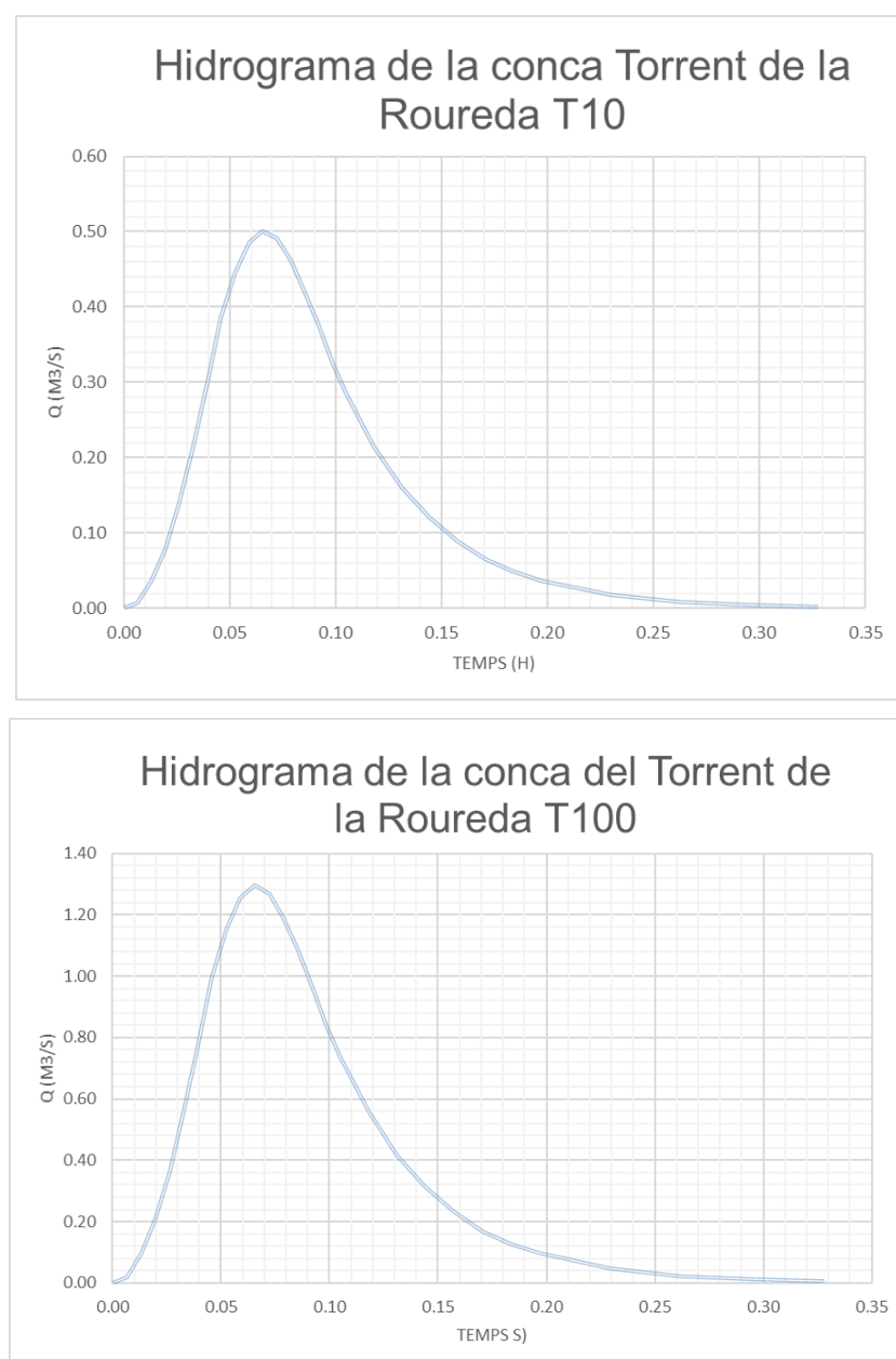
Figura 6. Hidrogrames de la conca del Torrent de Roureda T10 i T100
